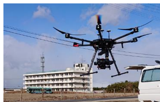
8Kカメラ搭載ドローン
