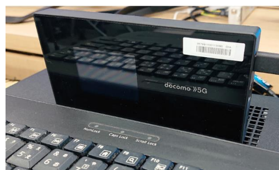
5G送受信機(据付型、ポータブル型) (5G→5Gで8K映像をダウンリンク)
