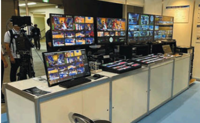
パナソニック コネクト出展のIT/IPプラットフォーム「KAIVOS」は、GPUで映像処理をすることで、ME数やKEY数に制約されないマルチレイヤー構成や、解像度・画角にとらわれない「CANVAS」スクリーンなど、自由な映像制作を可能とする
