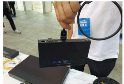
エーティエックはロック式HDMI2.0対応ケーブルも参考展示。ワンタッチで着脱できる。最大4K60Hz対応、最長100m伝送
