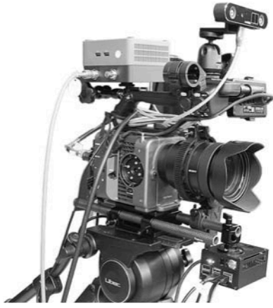
LinkBox2と位置情報検出センサー、LinkBox FIZのセッティング例
