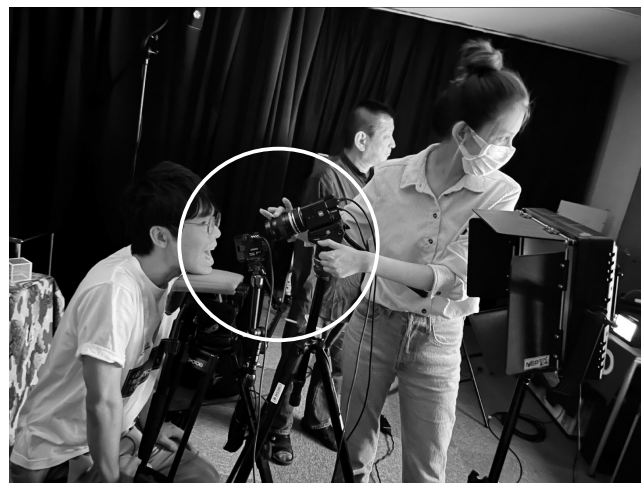
写真2 アストロデザイン株式会社にて 近赤外線対応カメラ8K MULTIPURPOSE CAMERAと 50mmマクロレンズを用いて口腔内を撮影している様子。
