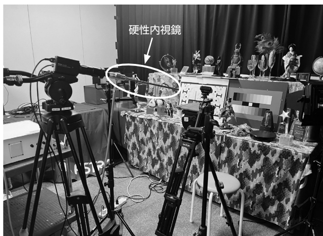
写真1 本実験で使用した機材 8K MULTIPURPOSE CAMERA AB-4841（アストロデザイン株式会社） 硬性内視鏡（矢印）は株式会社住田光学ガラスからご提供いただいた。
