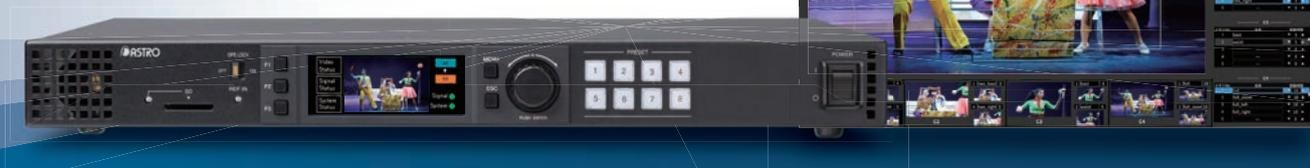
8K映像技術を活用した「ライブ撮影の業務効率化（1人で4カメの操作）」をご提案します。1台の8Kカメラで撮影した映像から、任意の4画面を切り出して4つのHD映像出力が可能です。この出力をSRTトランスミッターTR-5004と組み合わせれば、クラウド編集も可能となります。
